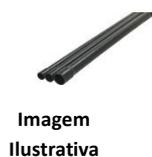
Os eletrodutos e curvas utilizados no projeto serão encontrados na entrada de energia e nos postes de derivação que levam os alimentadores principais até os cabos de distribuição. Estes eletrodutos são de polietileno flexível tipo pesado conforme bitola e orientação em projeto. As emendas dos eletrodutos são feitas com luvas próprias. Nas entradas e saídas tanto dos quadros quanto das caixas serão utilizados buchas e arruelas para acabamento.
