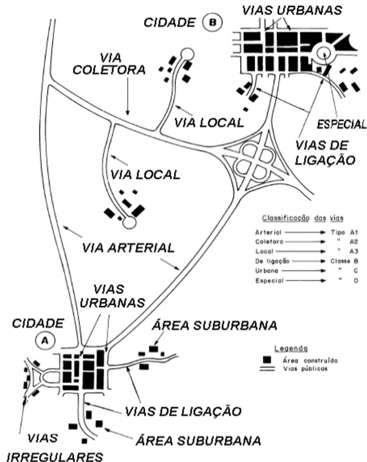
Figura 02: NBR 5101 Iluminação Pública – Tipos de Vias
